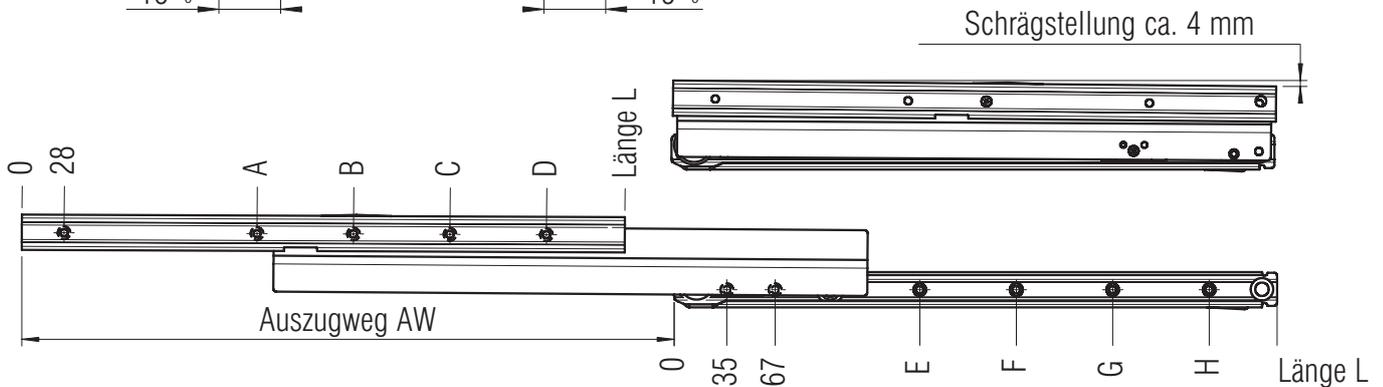
Anschraubbohrungen für 3,5 mm Spax-Schraube
